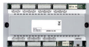
IXGWLCRY20 (200993) Adaptateur 20 contacts NO/NF/C pour IXG
