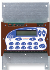
HECOMGSMV3 (150065) Centrale de gestion 2 entrées avec afficheur et clavier de programmation
