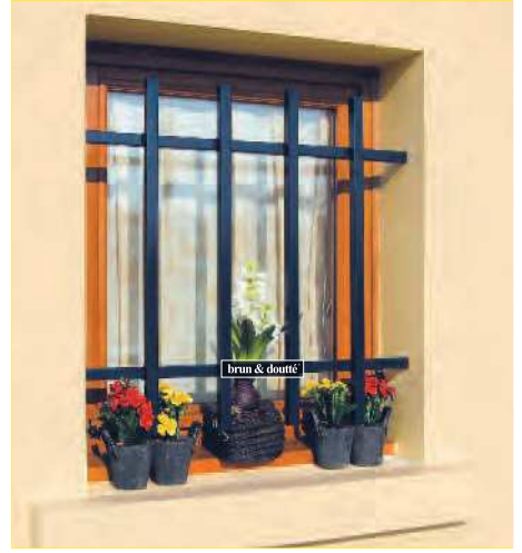
↑ Grille renforcée MISTRAL "R" Traverses en carré plein de 20 x 20 mm, barreaudage en carré plein de 20 x 20 mm. Pose en tableau. Cote de fabrication : - 15 cm en hauteur, + 16 cm en largeur pour scellement.
