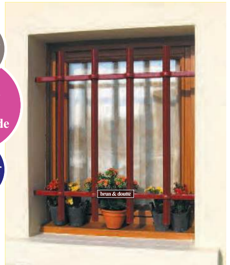
↑ Grille renforcée MÉNESTREL "R" Traverses forgées en carré plein de 20 x 20 mm à trous renflés pour le passage des barreaux en carré plein de 20 x 20 mm. Pose en tableau. Cote de fabrication : - 15 cm en hauteur, + 16 cm en largeur pour scellement.
