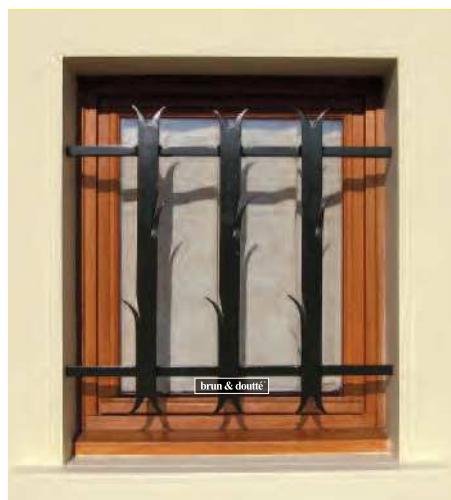
↑ Grille renforcée AQUITAINE "R" Traverses en carré plein de 20 x 20 mm, barreaudage en fer plein de 40 x 10 mm. Pose en tableau. Cote de fabrication : - 15 cm en hauteur, + 16 cm en largeur pour scellement.
