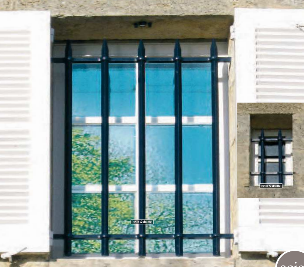
↑ Grille renforcée MISTRAL "R" Traverses en carré plein de 20 x 20 mm, barreaudage en carré plein de 20 x 20 mm. Pose en tableau. Cote de fabrication : - 15 cm en hauteur, + 16 cm en largeur pour scellement.
